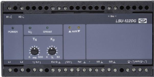
DEIF의 Uni-line 부하 공유 장치, LSU-122DG는 발전기 사이의 AVR 제어 포함 var 부하 공유를 제공하며, 전자 전위차계(EPQ96-2 또는 EPN-110DN)를 통해 거버너에 연결됩니다.
