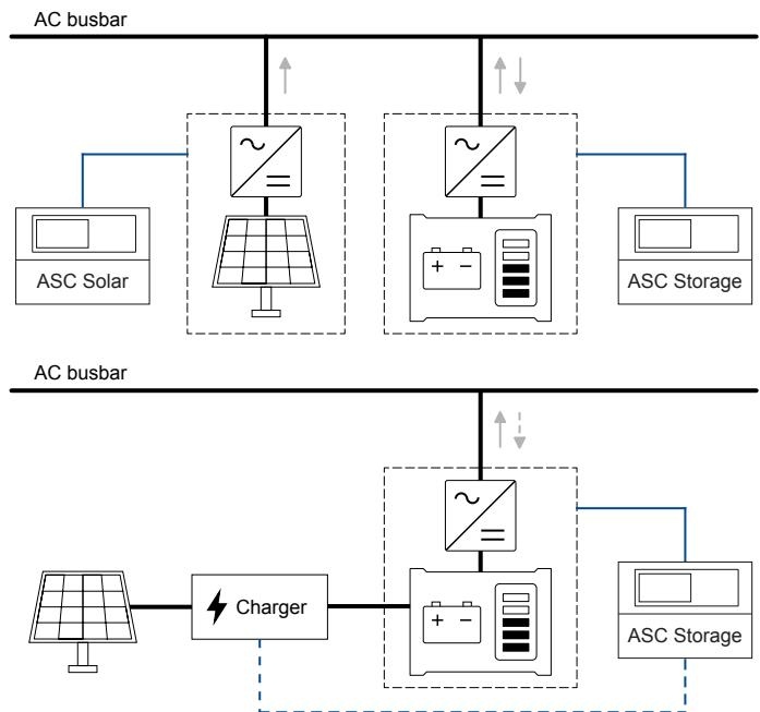
对于直流耦合系统，电池通过直流侧的光伏母排充电。ASC 150 Storage 控制器可以与直流侧的光伏逆变器通讯，并限制从光伏逆变器到电池的电流，具体取决于光伏电池系统架构和品牌类型。
