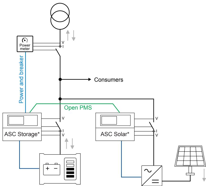
并网太阳能、储能、外部发电机组和外部主电网
