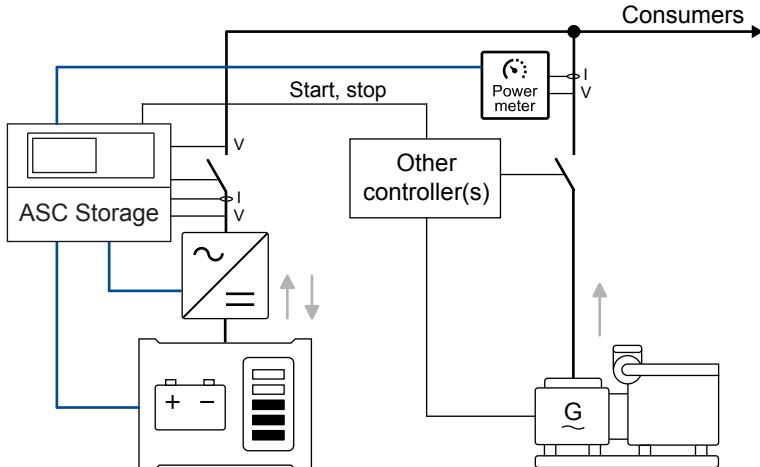
ASC 150 Storage 控制器可以调配负载，使发电机组可以在其最佳负载点运行。
