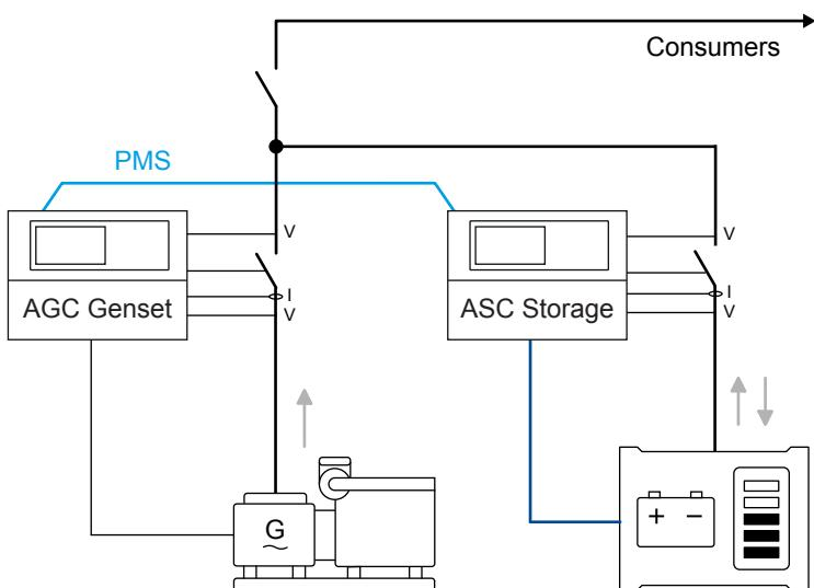
当发电机组开始改善电能质量时，ASC 150Storage 可以为峰值负载供电。ASC 150 Storage 控制器可以调配负载，使发电机组可以在其最佳负载点运行。如果 ESS 为母排负载供电，则 ESS 可以是连接到母排的唯一电源。
