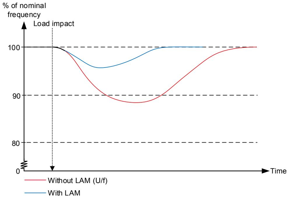
上图显示，随着 LAM 功能的发挥，在大负荷冲击后，频率会上升并更快地稳定下来。这是因为 LAM 功能将降低电压，从而降低发动机的扭矩。
