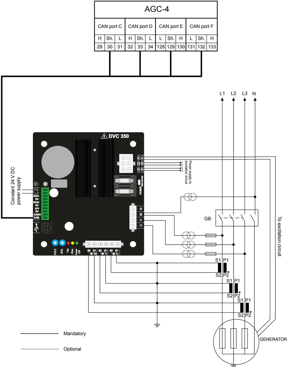
**备注** 如果 DVC 350 安装在测量线路的末端，则可以将 DVC 的 CT 输入端与 AGC-4 的 CT 输入端串行连接。在这种情况下，只需要一套电流互感器。这是因为 S2 端子内部短路。
