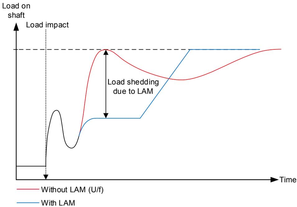
上图显示了启用和禁用 LAM 功能时发动机轴负载的比较。当 LAM 功能降低电压时，轴上的扭矩会变亮，从而使发动机在负载冲击后在 RPM 中更快地上升。因为 LAM 功能会提高系统的稳定性，在负载冲击后能够更快更稳定地达到额定值。
