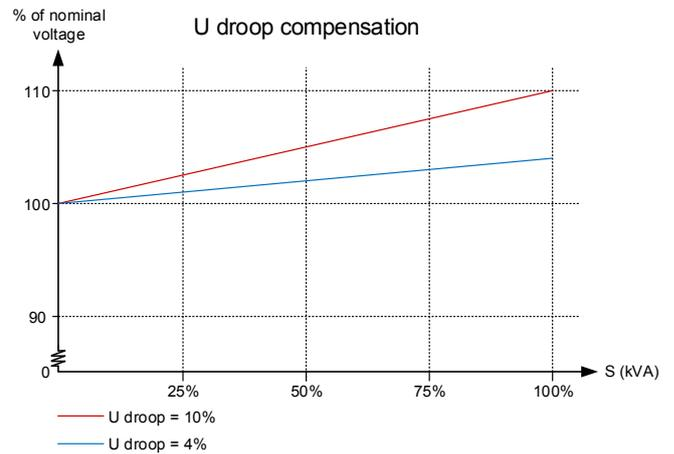
如果在 AGC 中关闭调节，则下垂补偿决定允许电压下降多少。可以通过将 AGC 设置为 MANUAL 来关闭调节。如果 CAN 总线电缆断线，调节也可能关闭。如果 CAN 总线线路出现错误，则可以利用降压功能为 DVC 350 提供一个电压设定点。这使得发电机组可以在没有可用接口时分担无功负载。
