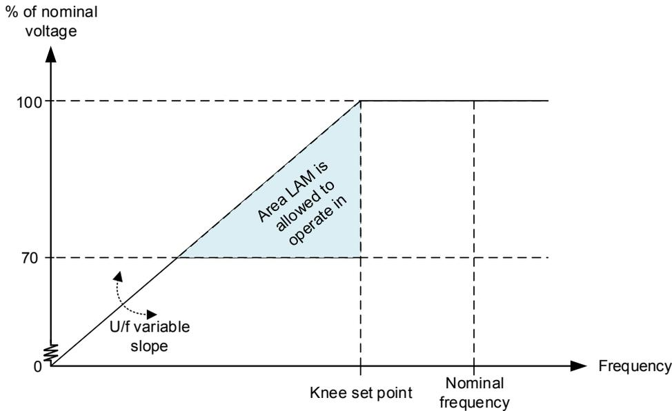
上图与 U/f 定律图非常相似。不同的是这里标记了一个三角形。启用 LAM 功能后，允许发电机组在标记的区域内。当应用了 U/f 定律时，DVC 350 永远不会越过图表中的 U/f 定律线，但会始终试图靠近它。当发电机组高于拐点设定点时，DVC 350 将调节到名义电压。但只要位于标记区域（三角形），DVC 350 将会使用 U/f 定律确定电压的设定点。
