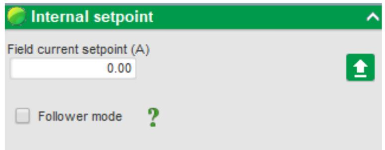
从调节模式切换到手动模式时，可以启用 **Follower 模式**（跟踪功能）。在该模式下，励磁电流测量值被用作参考值，可防止机器运行点出现明显的跳变。
