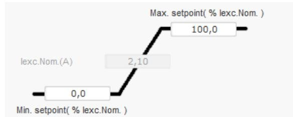
在本例中，最小电流设定点为 2.10 A 的 0%，最大电压设定点为 2.10 A 的 100%。
