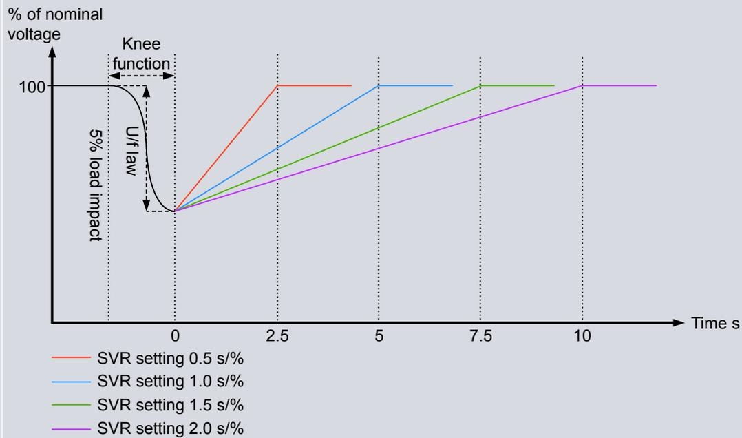
时间点 0 处的虚线表示频率开始恢复的位置。当频率开始恢复时，SVR 功能被激活。当发电机组因负载冲击而承受 5% 的电压降且 SVR 设置为 1.0 s/% 时，电压将在 5 秒内恢复。但是仍然无法通过 U/f 定律，这会使 SVR 超过例如 5 秒。如果发电机不能快速从负载冲击中恢复转速，就会发生这种情况。
