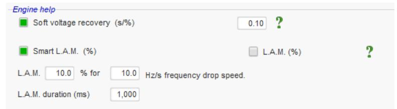
控制器测量工作频率并永久计算其导数。根据这一导数值，计算出电压的衰减系数 (K)，具体数值由用户配置的参数决定。
