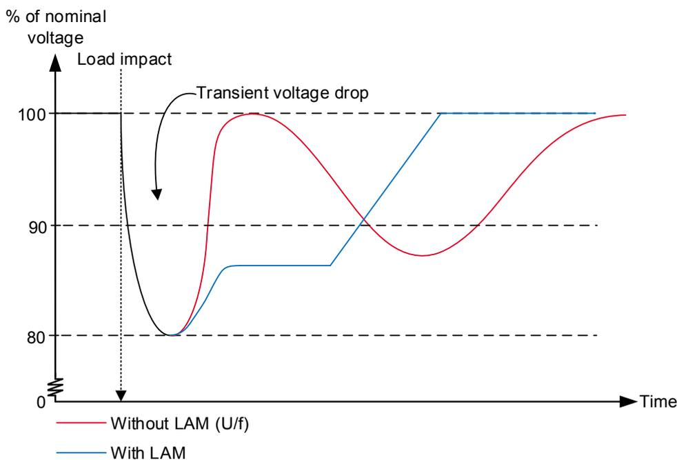
在上图中，进行了使用和不使用 LAM 功能的比较。如果不使用 LAM 功能，电压会在负载冲击时不稳定。在这里，只有从拐点函数的  $U/f$  定律决定电压设置点。使用 LAM 功能，可以短暂地降低电压。当频率再次上升时，LAM 功能将开始增加电压。电压上升的坡度由软电压恢复功能控制，稍后将对此进行描述。
