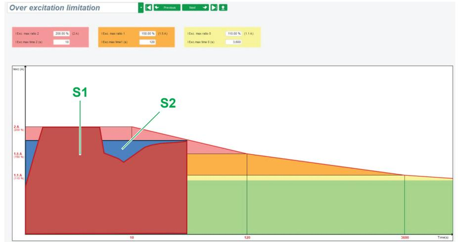
然后将 **S1** "场电流测量 x 时间" 区域（红色显示）与 **S2** "最大场电流 x 时间" 区域（蓝色显示）进行比较。
