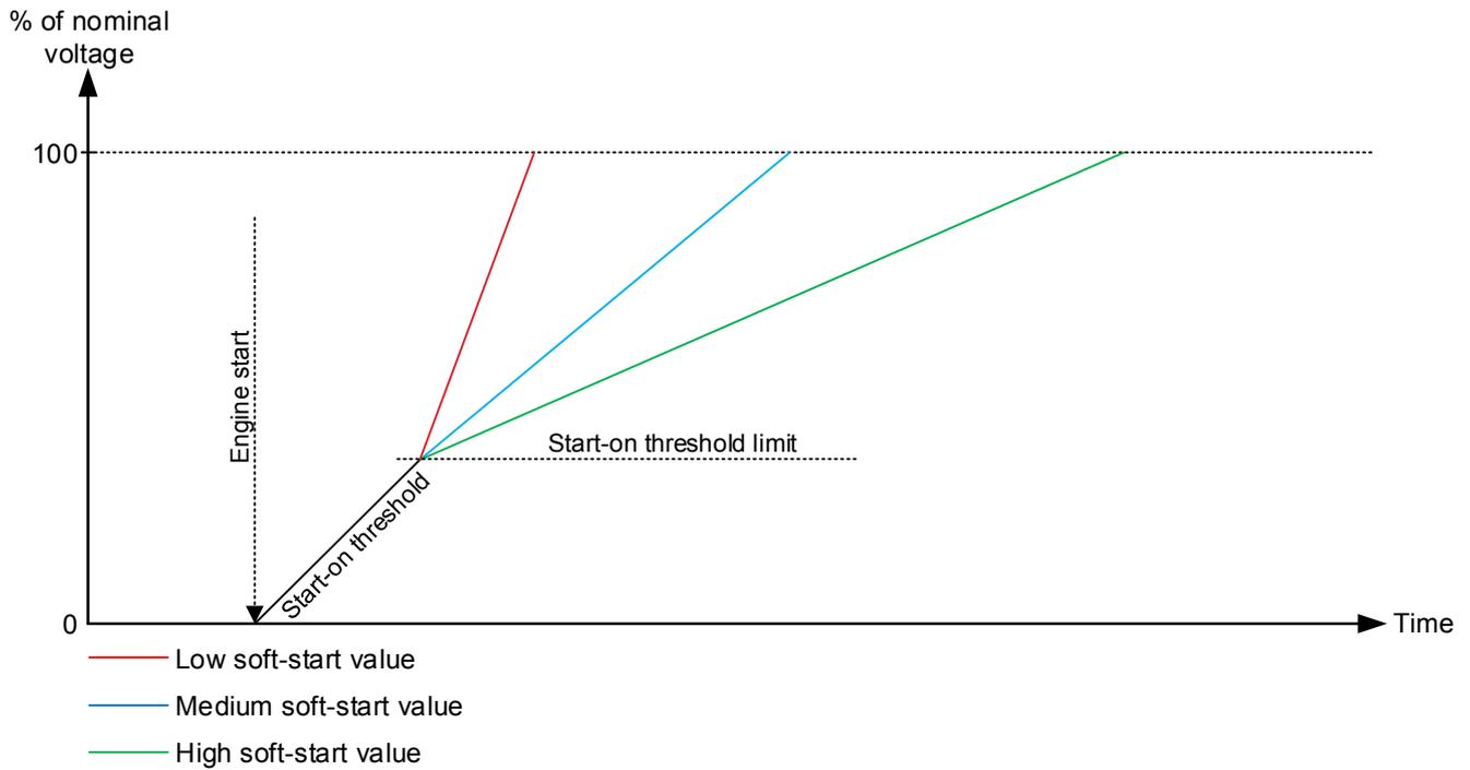
由于软启动计时表示将电压从 0 V 提高到额定电压所需的时间，如果同时使用启动阈值功能，则不会使用全计时。
