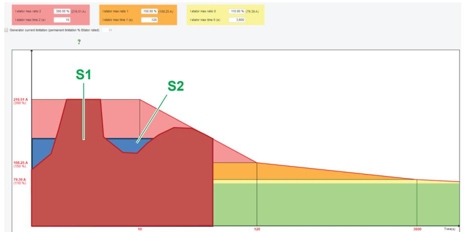
然后将 **S1** "定子电流测量 x 时间" 区域（红色显示）与 **S2** "最大定子电流 x 时间" 区域（蓝色显示）进行比较。
