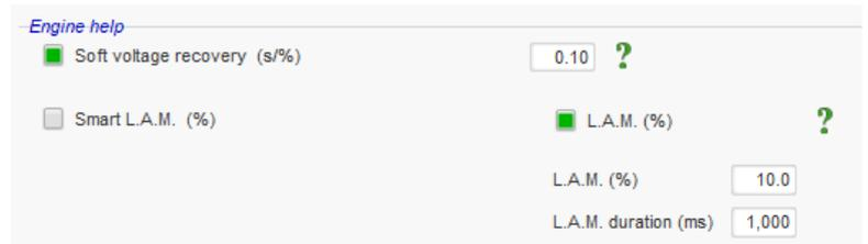
当测得的发电机频率低于配置中指定的欠速膝点（例如 48 Hz 或 57 Hz）时，电压设定点将降至指定值（在上例中，额定电压的 10%）。
