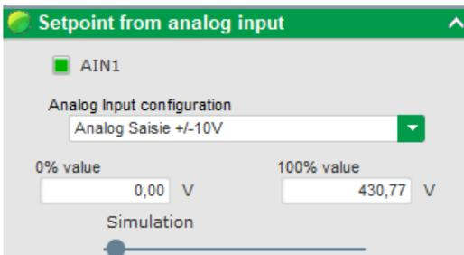
还可以通过将参数 2783 (AGC-4)/2782 (AGC 150) 切换为模拟量而不是 EIC，从 AGC 设置模拟量调节。请留意传感器输出也在参数 5991 设置。在参数 7796 中，DVC 350 上的输入类型被设置，并需要有一个模拟量。要启用发送所有这些指令，必须启用参数 7805。这样，就可以通过 CAN 总线发送所有指令，并使用参数 7796 通过模拟量偏置控制 DVC 350。
