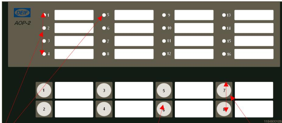
LED 1-5 zeigen die CAN-Nr. an. Drucktaste Eingabe/Verlassen
