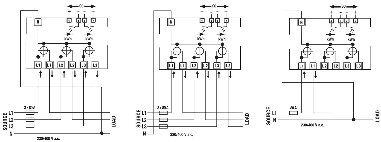
**“Der N-Leiter am muß Power-meter angeschlossen werden”**
