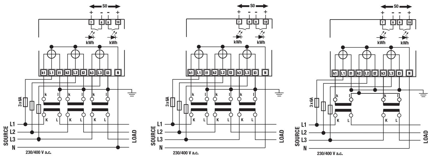
**“Der N-Leiter am muß Power-meter angeschlossen werden”**
