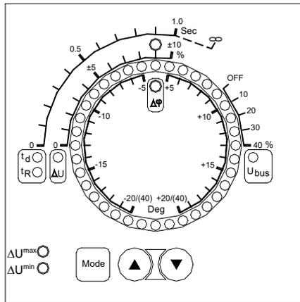
El CSQ-3 puede funcionar en dos modos diferentes: «Modo normal» y «Modo de ajuste». El modo normal se utiliza para mostrar los valores de medición, mientras que el modo de ajuste sirve para visualizar o cambiar los ajustes según las funciones deseadas.
