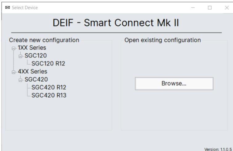
5. Podrá ver el dispositivo conectado en la esquina inferior izquierda de la pantalla de smart connect.
