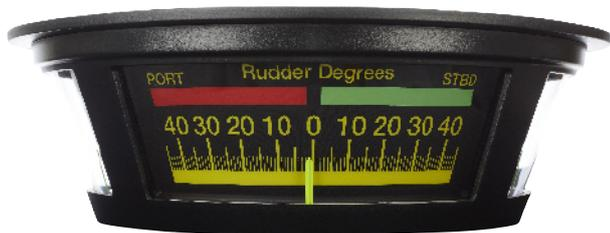
TRI-2はブリッジでの舵角位置のインジケータ－として使用します。インジケータ－は、3個のポインタ－が共用シャフトに取り付けられた堅牢な可動コイルシステムから成ります。アナログ入力を擁する場合に適します。CAN入力の場合、CANインタ－フェースのあるTRI-2をご参照ください。
