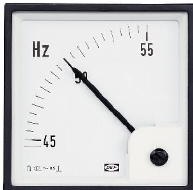
Avec sa haute immunité au 3<sup>ème</sup> harmonique, le fréquencemètre à aiguille FQ de DEIF est adapté à toutes les applications. L'indicateur à bobine mobile propose une électronique intégrée pour convertir la fréquence lue en analogique en affichage linéaire sur une échelle interchangeable
