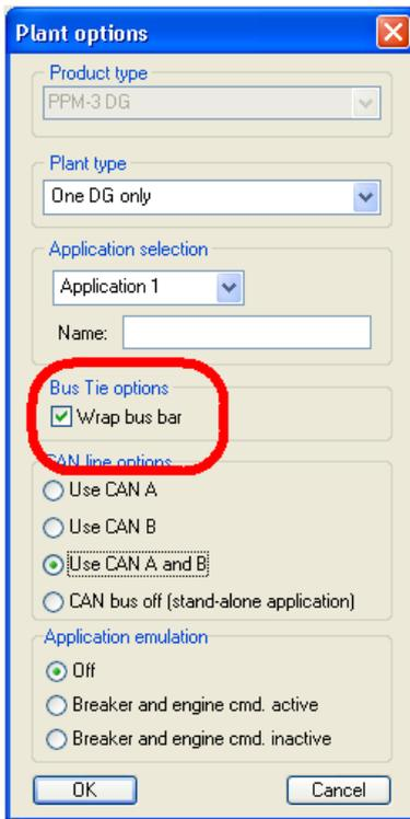
Pour permettre la connexion en boucle fermée sur le jeu de barres, le paramètre 8990 (Closed Ring) doit être réglé sur ON.
