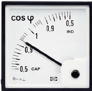
Le mètre de facteur de puissance PFQ mesure le cos phi avec une bobine mobile et un transducteur électronique. Le transducteur mesure l'angle de phase entre une tension AC et l'intensité AC correspondante, convertit le signal en intensité DC proportionnelle, laquelle est transmise à la bobine mobile.
