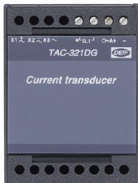
Puissantes, rapides, et compactes, les unités de la gamme transducteurs de DEIF mesurent le courant alternatif et / ou le signal d'intensité et fournissent un signal en sortie, soit d'intensité, soit de tension, proportionnel aux mesures prises vers des PLC, des PC, des contrôleurs de microprocesseur, des indicateurs, des unités d'alarmes, etc.
